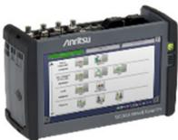
5Gはバックボーンのネットワーク評価も重要です。5G基地局のインターフェースとなるeCPRI/RoEのスループットや遅延測定、高精度な時刻同期試験もサポートします。
