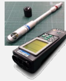
テストー 多機能環境測定器 Testo445 一式
