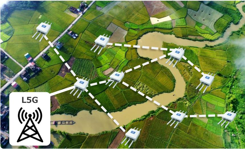
バックホールを指向性アンテナに付け替えて通信距離を1kmに延長!
