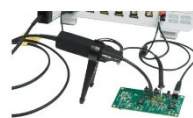
テクトロニクス 光アイソレーション 差動プローブ TIVP1
