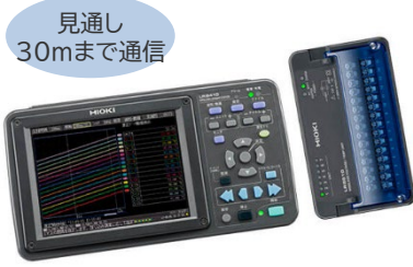
見通し 30mまで通信 日置電機 ワイヤレスロギングステーション LR8410
