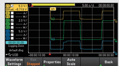
データログ機能による電圧電流変動測定*
