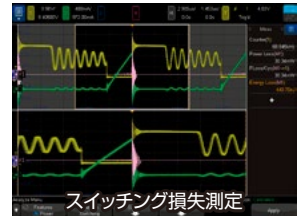
スイッチング損失測定
