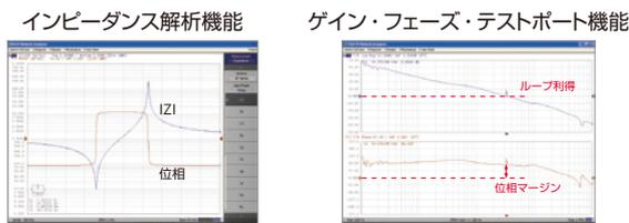
アナライザによるキャパシタ、インダクタ、共振器などの電子部品のインピーダンスパラメータの測定が可能。
