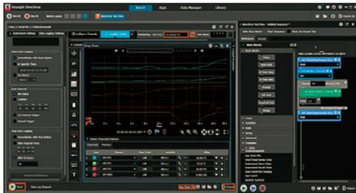
Pathwave BenchVue DAQソフトウェアを使えば、DAQ970AS/937Aのチャンネル設定、データロギングなどがPCから簡単に制御が可能です。
